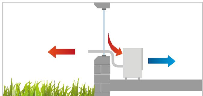
Die angesaugte Luft wird gefiltert, entfeuchtet und gekühlt dem Raum wieder zugeführt. Sobald die gewünschte Raumtemperatur erreicht ist, schaltet der Außenluft-Ventilator ab. Unabhängig davon, zirkuliert der Innenraum-Ventilator die Raumluft konstant weiter. Durch einen flexiblen Abluftschlauch wird die Wärme und die Feuchtigkeit nach außen geleitet. Dafür brauchen Sie ein Fenster oder eine Tür nur einen Spalt weit zu öffnen.
