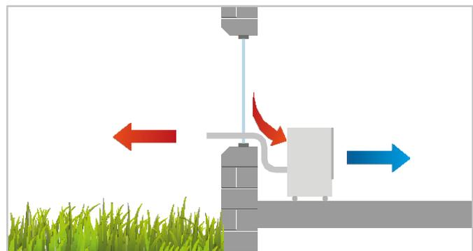
Die angesaugte Luft wird gefiltert, entfeuchtet und gekühlt dem Raum wieder zugeführt. Sobald die gewünschte Raumtemperatur erreicht ist, schaltet der Außenluft-Ventilator ab. Unabhängig davon, zirkuliert der Innenraum-Ventilator die Raumluft konstant weiter. Durch einen flexiblen Abluftschlauch wird die Wärme und die Feuchtigkeit nach außen geleitet. Dafür brauchen Sie ein Fenster oder eine Tür nur einen Spalt weit zu öffnen.
